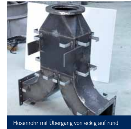
Bogenstück eines Rauchgaskanals
